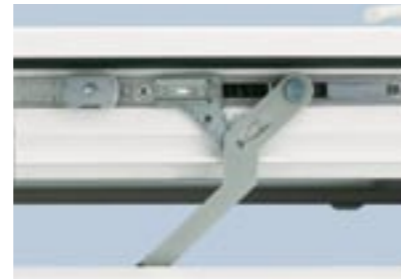
Wielostopniowy uchył po przekręceniu klamki o 45° można zablokować skrzydło w jednej z wielu pozycji uchylenia. Stabilizator uchyłu aktywuje się automatycznie w chwili uchylenia skrzydła.
